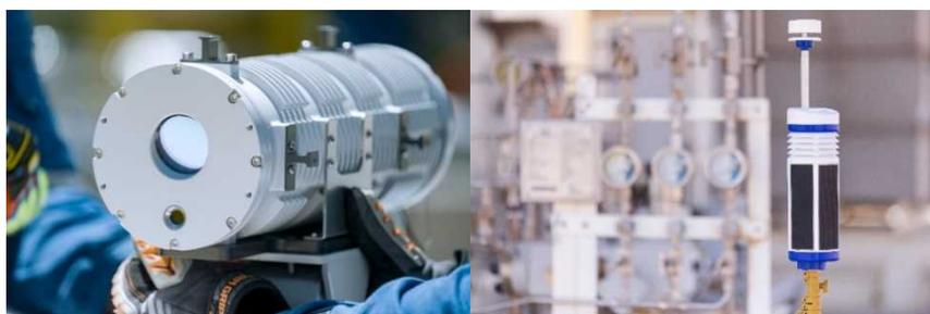
LiDAR カメラ（左）と固定センサー（右）
